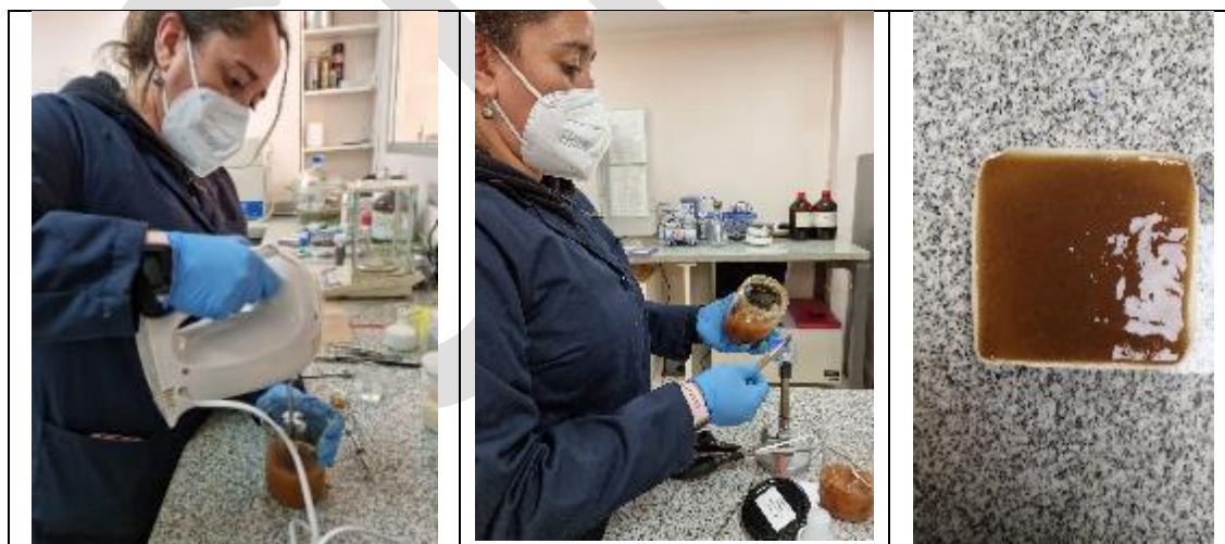
Figura 5. Prueba y análisis de disolución en agua y mezclas con Glicerol al 99,5% de pureza, para la muestra original.
